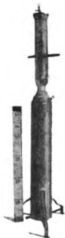
Zendlamp van 30 K.W. (model 1923) met een koperen anode, die door stroomend water afgekoeld wordt. De lengte van deze lamp is c.a. 95 c.M.
